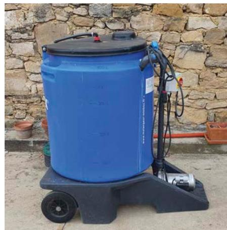
Les mélangeurs en cuve fermée permettent une meilleure incorporation des poudres dans l'eau.
